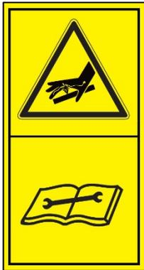
Gefahr durch austretendes Hydrauliköl unter hohem Druck!
