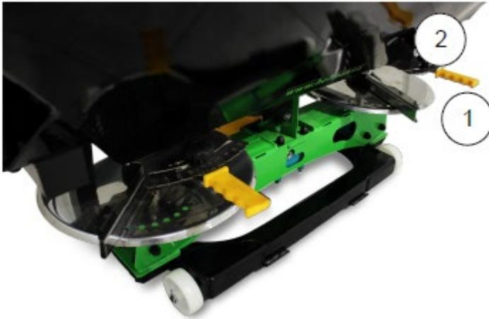
Die hebelgesteuerten Dämpfereinstellungen werden in der folgenden Reihenfolge angepasst:
