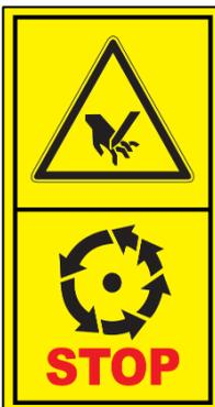
Aufgrund dieser Gefahr besteht die Gefahr durch Quetschen oder Schneiden von Fingern oder Händen durch rotierende, sich bewegende Maschinenteile!
