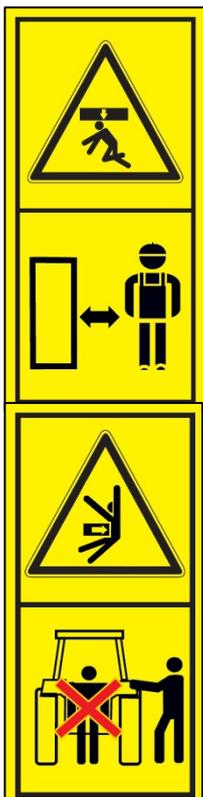
Quetschgefahr für den gesamten Körper durch Aufenthalt unter schwebenden Lasten oder angehobenen Maschinenteilen!
