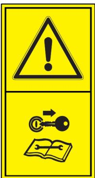
Gefährliche Situationen für Bediener durch unkontrolliertes Anlaufen/Bewegung der Maschine bei allen Eingriffen an der Maschine, z.B. bei der Montage, Einstellung, Fehlerbehebung, Reinigung oder Wartung.
