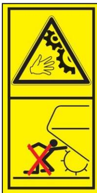
**Gefahr durch Quetschen oder Einzug der Körperteile wegen drehender, sich bewegender Maschinenteile!**
