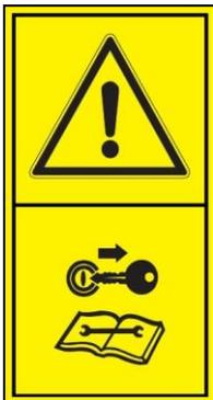
Gefahr für Bediener durch unkontrolliertes Anlassen/Bewegen der Maschine bei allen Arbeiten an der Maschine, z.B. während dem Einbau, der Einstellung, Störungsbeseitigung, Reinigung oder Reparatur.
