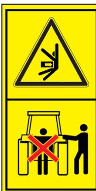
Gefahr durch Quetschen oder Stoß im Bereich zwischen dem Heck des Traktors und der Maschine beim Ankuppeln und Abkuppeln der Maschine!
