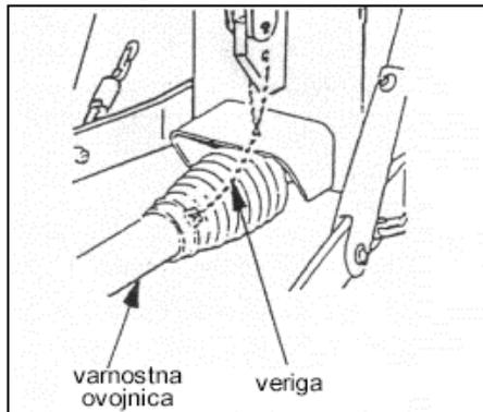
1. Die Zapfwelle an die Ballenpresse und den Traktor montieren.
