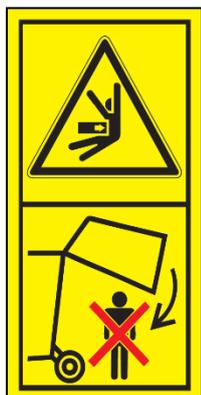
Gefahrstellen durch ungeschützt bewegte Maschinenteile!
