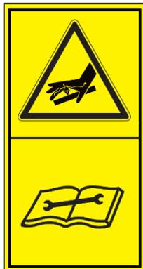
Gefahr durch ausfließen des Hydrauliköls unter Hochdruck!
