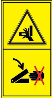
Aufgrund dieser Gefahr besteht die Quetschgefahr für Finger oder Hand durch leicht zugängliche, bewegliche Maschinenteile!
