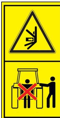
Beim An- und Abkuppeln der Maschine besteht Quetsch- und Stoßgefahr im Bereich zwischen dem Heck des Traktors und der Maschine!
