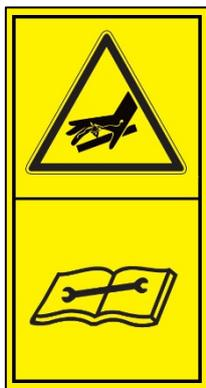
Gefahr durch austretendes Hydrauliköl unter hohem Druck!
