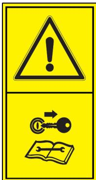
Gefährliche Situationen für Bediener durch unkontrolliertes Anlaufen/Bewegung der Maschine bei allen Eingriffen an der Maschine, z.B. bei der Montage, Einstellung, Fehlerbehebung, Reinigung oder Wartung.
