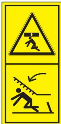
Quetschgefahr für den gesamten Körper durch die Bewegung des beweglichen Teils der Maschine!
