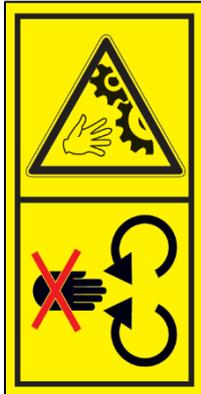
Aufgrund dieser Gefahr besteht die Gefahr durch Quetschen oder Schneiden von Fingern oder Händen durch rotierende, bewegliche Teile der Maschine!
