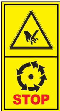
Aufgrund dieser Gefahr besteht die Gefahr durch Quetschen oder Schneiden von Fingern oder Händen durch rotierende, sich bewegende Maschinenteile!
