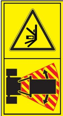
Quetschgefahr für den gesamten Körper durch Maschinenschwingungen!
