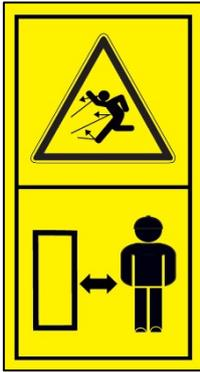
Verletzungsgefahr durch aus der Maschine herausgeschleuderte Materialien und Fremdkörper!
