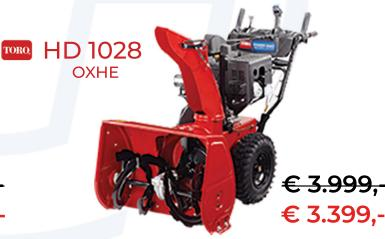
Antrieb: Reibscheibe Leistung: 7,4 kW / 10 PS Hubraum: 302 cm<sup>3</sup> Starter: Elektro – 230 V Räumbreite: 71 cm
